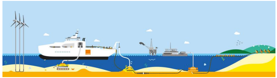
FIGURE 3 INSTALLATION D'UN CABLE SOUS-MARIN 4
